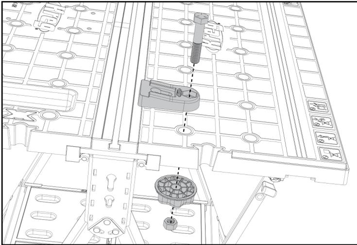
Ensamble la base de la abrazadera de banco como se muestra. Alinee la tuerca hexagonal con la ranura en la perilla y apriete la perilla, colocando la tuerca en la ranura. La tuerca permanece en su lugar para usarla en el futuro.
